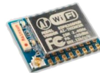
Рис 2. Wi-Fi-модуль ESP-07 Ai-thinker.
