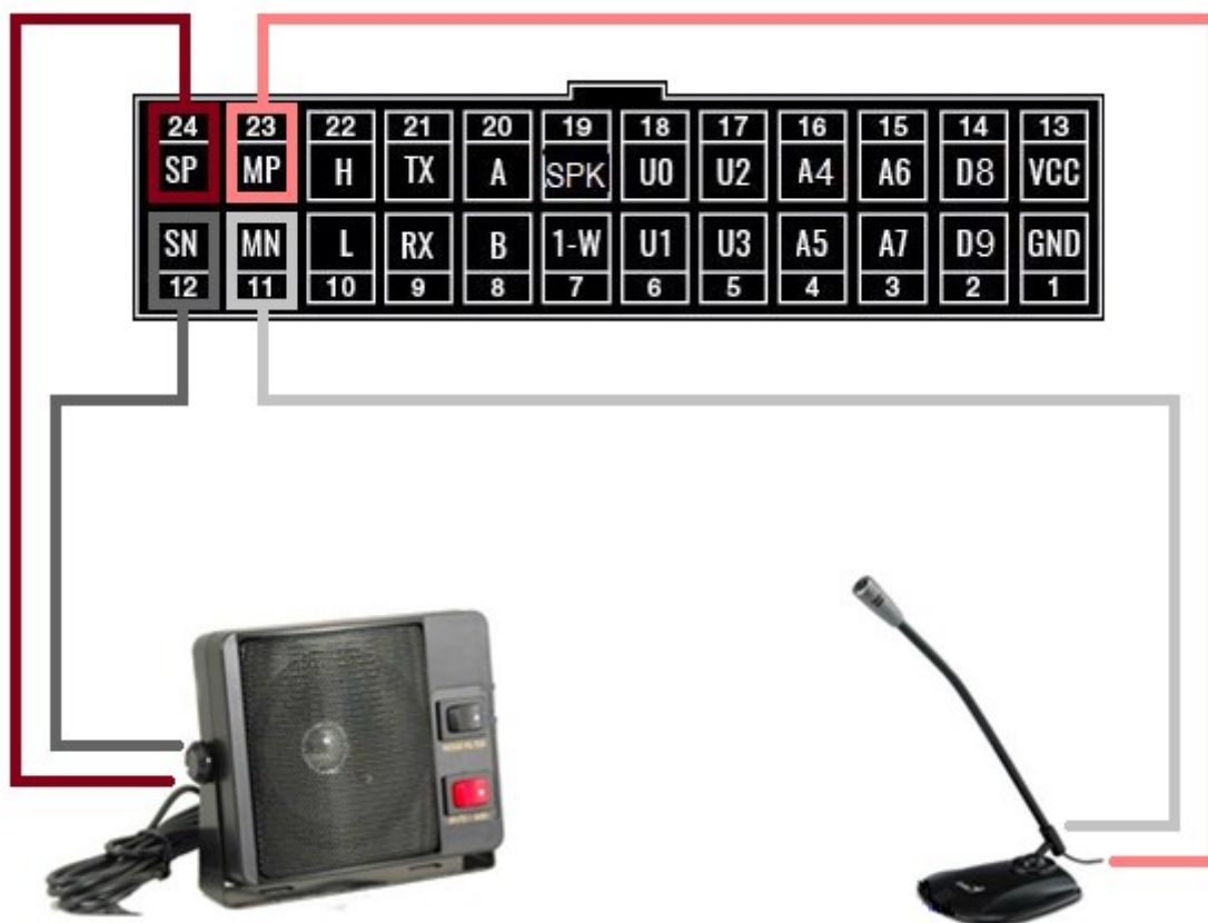
Рисунок 23 – Схема подключения микрофона и динамика
